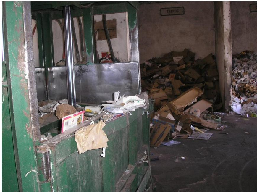
Cuenta además con otro sector cubierto para el prensado de distintos tipos de plásticos, aluminio, hojalata y tetrabrick, con dos prensas exclusivas para enfardar estos materiales.
